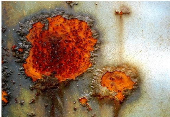
Reacciones físicas de corrosión sobre un metal (casco de un barco).
