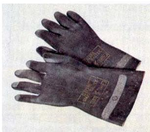
Los guantes aislantes (dieléctricos) de baja tensión, están fabricados en caucho natural o sintético, neopreno u otro material de características similares de resistencia mecánica y aislante eléctrica. Carecen de costuras, grietas o perforaciones que podrían disminuir sus propiedades dieléctricas.
